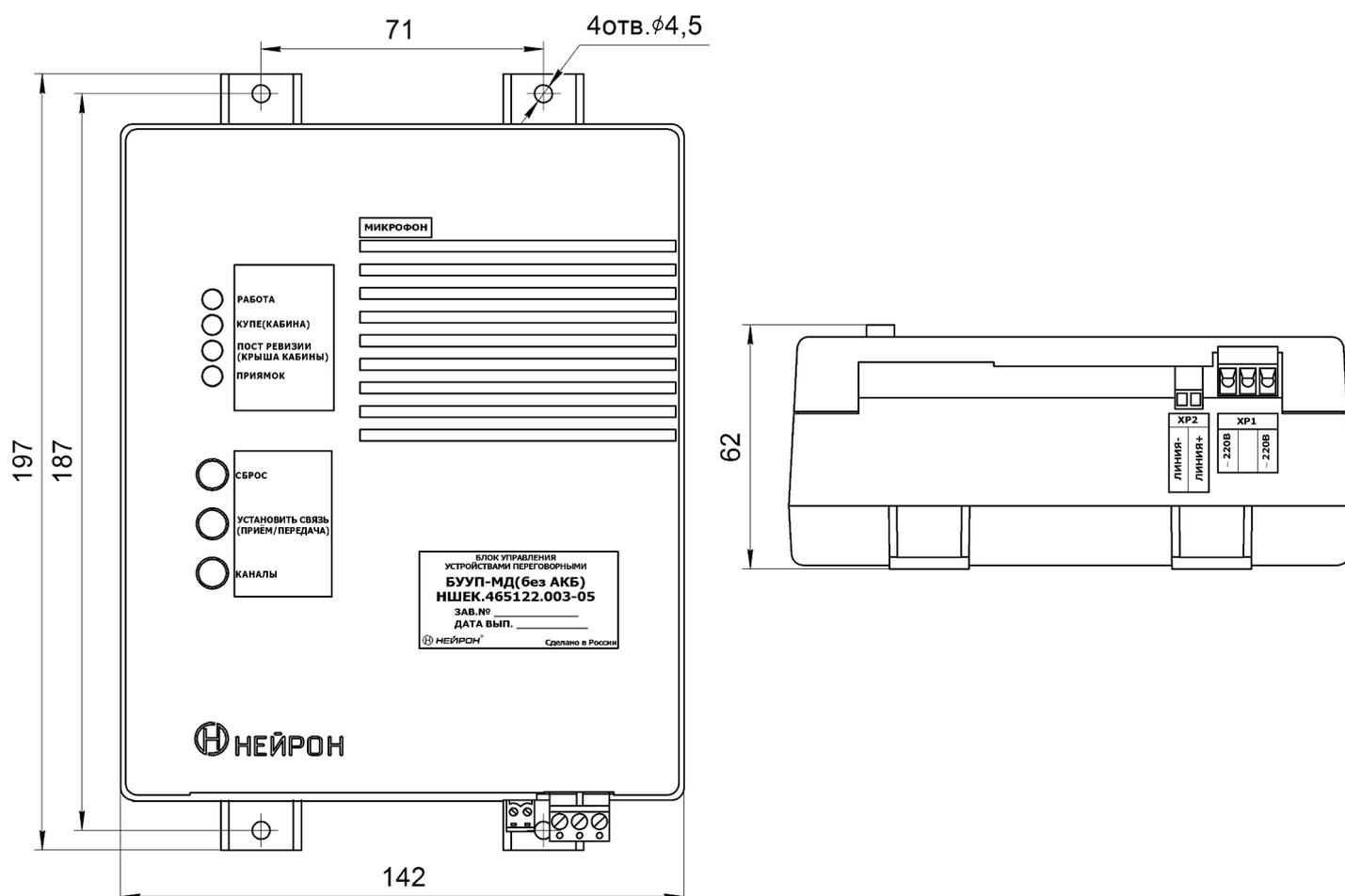
Рис.1 Внешний вид Блока управления устройствами переговорными «БУУП-МД(без АКБ)» НШЕК.465122.003-05
